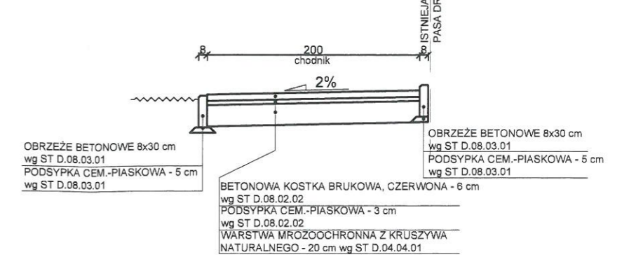
PRZEKRÓJ NORMALNY CHODNIK od 0+525 do 0+751 od 0+775 do 1+227 od 1+817 do 1+910
